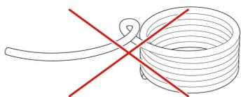
В процессе размотки не допускается заламывать и перегибать ГПИ-трубу
