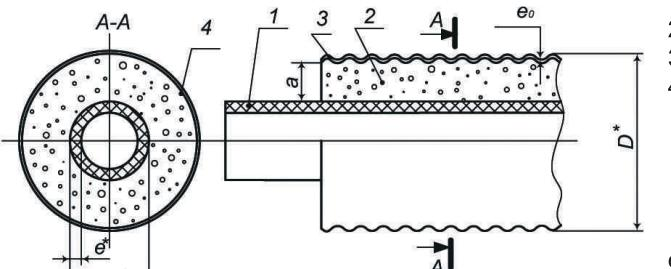
**Рис. 1.4 – Конструкция ГПИ-трубы ИЗОКОМ 95/0,6**
