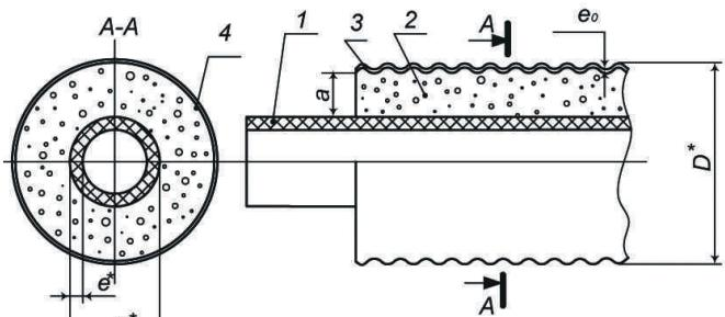
**Рис. 1.2 – Конструкция ГПИ-трубы ИЗОКОМ А 95/1,0**
