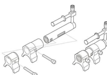
6 Подготовить гидравлический инструмент к работе: установить на гидроцилиндре опорную и подвижную губки, закрепить их фиксаторами. Необходимый размер губок тисков выбирается в зависимости от типоразмера пресс-фитинга.
