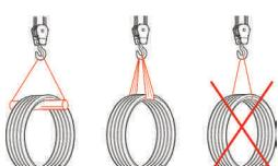
При проведении погрузочно-разгрузочных работ следует соблюдать осторожность для исключения возможности возникновения механических повреждений полиэтиленовой оболочки ГПИ-труб.
