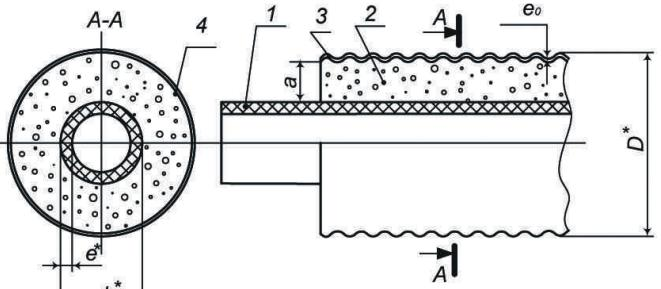
**Рис. 1.3 – Конструкция ГПИ-трубы ИЗОКОМ А 115/1,0**
