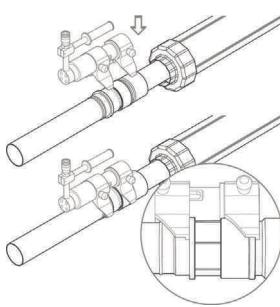
7 Установить гидравлический инструмент таким образом, чтобы подвижная опорная губка тисков вошла в сцепление с буртами на гильзе надвижной и втулке пресс-фитинга
