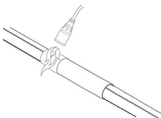
6. Прогреть пламенем газовой горелки полиэтиленовую оболочку с двух сторон стыка. Обернуть вокруг прогретой оболочки и зафиксировать ленту kleевой с двух сторон стыка. Надвинуть муфту на место стыка. Усадить муфту пламенем газовой горелки.
