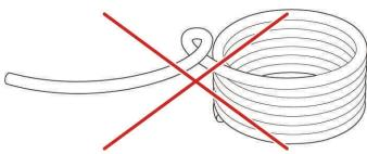
В процессе размотки не допускается заламывать и перегибать ГПИ-трубу
