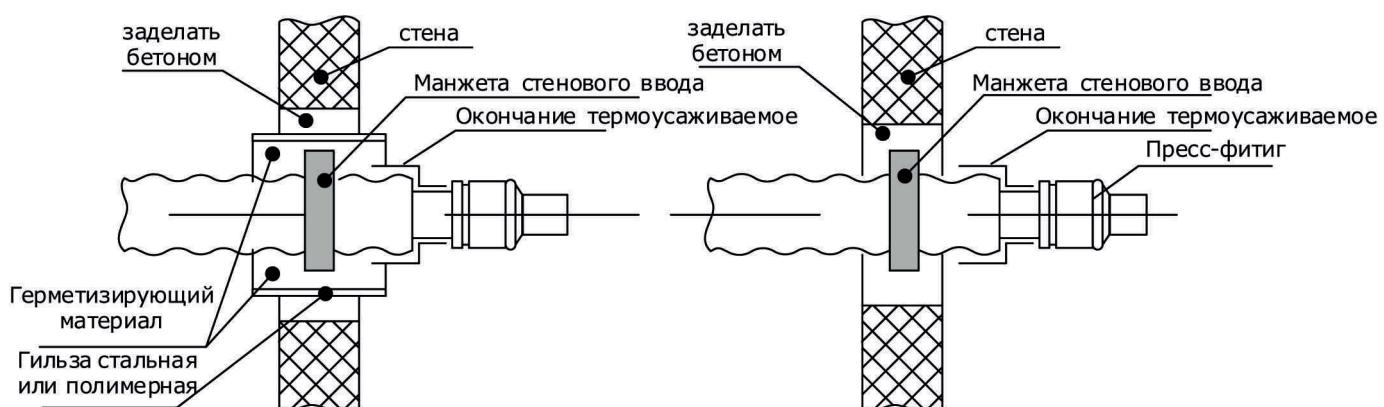
*Рисунок 8 – Герметизирующий узел ввода в здание*
