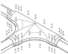
6. Соединить верхнюю и нижнюю половины полимерного кожуха при помощи крепежных элементов.
