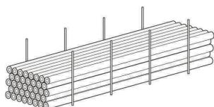
При хранении труб в штабелях высота штабеля выбирается в зависимости от диаметра ГПИ-труб (но не более двух метров). Высота штабеля должна исключать возможность деформации ГПИ-труб и обеспечивать легкий доступ к верхним рядам. Штабелированные ГПИ-трубы должны быть зафиксированы для предотвращения случайного выпадения или раскатывания ГПИ-труб путем установки по всей его ширине надежных ограничителей.
