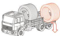
Запрещается сбрасывать ГПИ-трубы (бухты с трубами) с любой высоты. Допускается производить разгрузку бухт с ГПИ-трубами перекатыванием. При этом следует особо следить за тем, чтобы оболочка трубы при перекатывании не была повреждена камнями и другими предметами, имеющими острые
