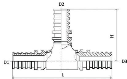
*Таблица 2.7.1 Пресс – тройник равнопроходной для ГПИ-труб ИЗОКОМ 95/1,0*
