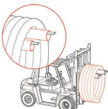
При использовании погрузчика вилы должны быть оборудованы мягкими прокладками (например, обрезки картонных или полиэтиленовых труб). Также необходимо принять меры, направленные на предотвращение соскальзывания бухты с вил погрузчика.
