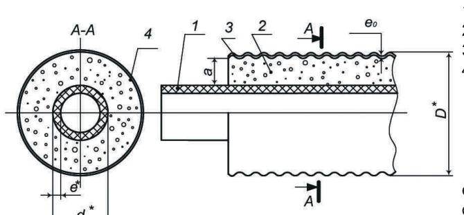
**Рис. 1.1 – Конструкция ГПИ-трубы ИЗОКОМ 95/1,0**
