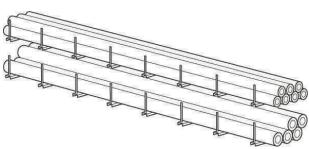
При хранении ГПИ-труб на оборудованных складах рекомендуется осуществлять хранение на стеллажах. Расстояние между опорами стеллажа не должно превышать один метр. Концы ГПИ-труб в штабеле (на стеллаже) должны быть ориентированы таким образом, чтобы этикетки (маркировка) труб располагалась в одном месте. Это облегчит их последующую идентификацию. Также необходимо обеспечить свободный доступ к маркировке ГПИ-труб.
