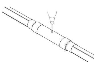
9. Перьевым сверлом (D=20 мм) просверлить отверстие для заливки пенополиуретана
