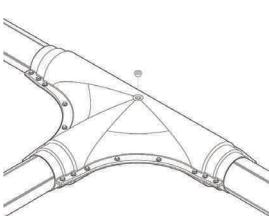
8. После завершения процесса пенообразования закрутить герметизирующую пробку (рис. 4.6.8).
