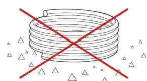
Площадка для хранения ГПИ-труб должна быть плоской, без камней и других предметов, имеющих острые кромки или абразивные поверхности, которые могут повредить полиэтиленовую оболочку ГПИ-труб.
