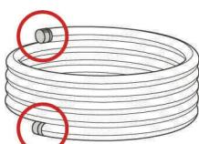
Торцы ГПИ-труб должны быть защищены заглушками заводского изготовления или полиэтиленовой пленкой толщиной не менее 100 мкм в два слоя с фиксацией ее клейкой лентой. Заглушки (или защитная пленка) снимаются после транспортировки ГПИ-трубы к месту проведения монтажных работ и размотки ее вдоль траншеи (или в траншее) непосредственно перед началом работ.
