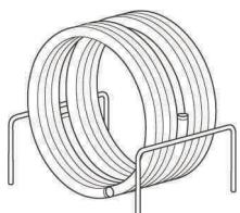
В случае непродолжительного хранения (например, на строительном площадке) допускается хранение бухты в вертикальном положении. При этом должны быть предприняты меры, направленные на предотвращение возможности самопроизвольного скатывания бухты.
