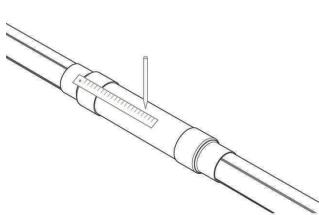
8. С помощью линейки (рулетки) определить среднюю точку на верхней поверхности муфты, нанести метку
