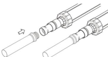
5 Вставить втулку пресс-фитинга с приваренным металлическим патрубком внутрь напорной ГПИ-трубы до упора.
