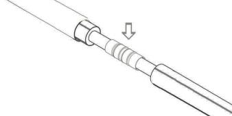
3. Обезжирить растворителем (или другим спиртосодержащим раствором) полиэтиленовую оболочку ГПИ-труб с обеих сторон от стыка на расстоянии 150-200 мм
