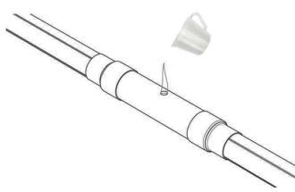
10. Приготовить смесь компонентов ППУ путем перемешивания их при помощи электродрели со специальной насадкой в полимерном ведре. Залить полученную смесь через приготовленное отверстие. Вставить в заливочное отверстие пробку дренажную.
