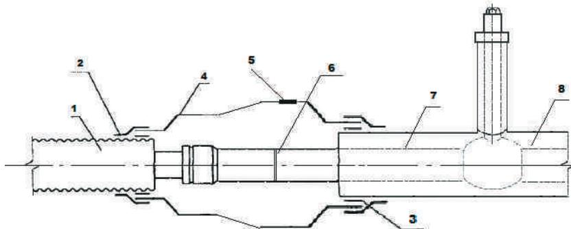
**Рисунок 6 - Конструкция переходного стыкового соединения с ГПИ-трубой на стальное Пи-изделие с переходной термоусаживаемой муфтой.**
