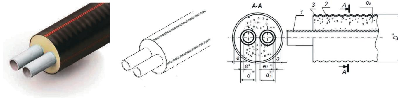
*Таблица 1.5 ГПИ-труба ИЗОКОМ 95/0,6 двухтрубного исполнения*
