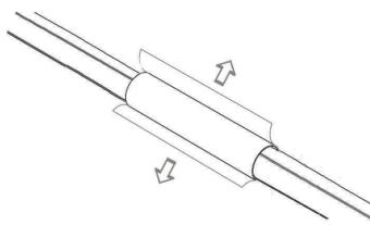
5. Удалить упаковочную пленку с поверхности муфты. Надвинуть муфту на стык, расположив ее в соответствии с ранее нанесенными рисками.
