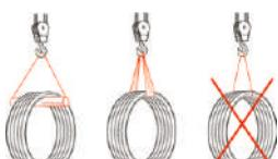
При проведении погрузочно-разгрузочных работ следует соблюдать осторожность для исключения возможности возникновения механических повреждений полиэтиленовой оболочки ГПИ-труб.
