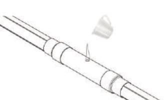
10. Приготовить смесь компонентов ППУ путем перемешивания их при помощи электродрели со специальной насадкой в полимерном ведре. Залить полученную смесь через подготовленное отверстие. Вставить в заливочное отверстие пробку дренажную.
